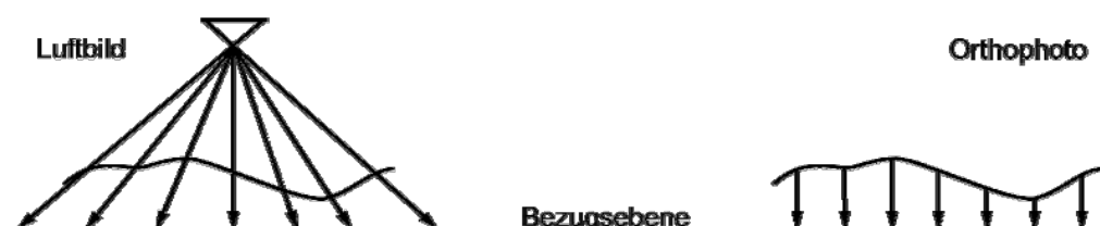
Abb. 9: Projektionsstrahlen des Luftbildes (links) und des Orthophotos (rechts) [9]
